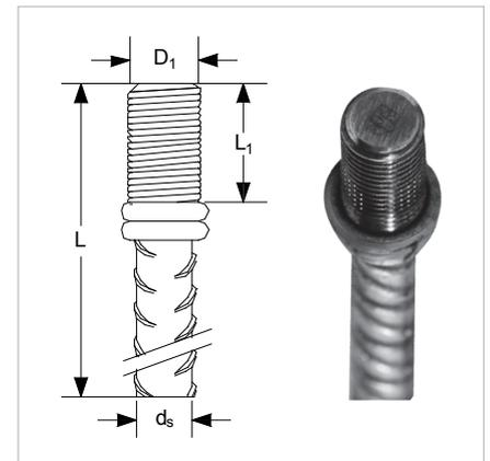
Zur Gewährleistung einer sicheren Kraftübertragung muss der Gewindestab mit einem Drehmoment-schlüssel kontrolliert und mit dem jeweiligen Drehmoment (M) aus der Tabelle 2 angezogen werden. Bei erforderlichen Aufbiegungen sind die Biegeradien entsprechend der jeweiligen nationalen Norm für den Stahlbetonbau zu beachten. Drehmomentschlüssel auf Anfrage.
