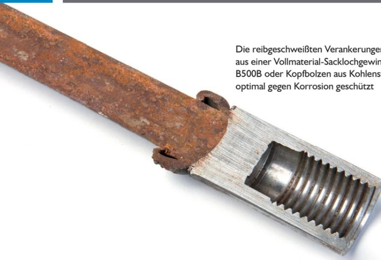
Die reibgeschweißten Verankerungen - RS Schwerlastanker Typ HA und Liste 20 SL Typ FW - bestehen aus einer Vollmaterial-Sacklochgewindehülse aus nichtrostendem Edelstahl reibgeschweißt auf Betonstahl B500B oder Kopfbolzen aus Kohlenstoffstahl. Bei einer Hülslenlänge >= 60 mm ist die Reibschweißnaht optimal gegen Korrosion geschützt
