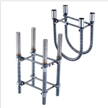
Der Schroeder RS-Schwerlastanker mit der DIBt-Zulassung Z-30.6-70 ist ein Verankerungssystem bestehend aus Edelstahlgewindehülse oder -bolzen A4 reibverschweißt auf Betonstahl B500B und ist lieferbar inklusive aller Befestigungsmittel (Gewindestangen, Muttern, Unterlegscheiben, Keilsicherungsscheiben und Elastomerscheiben). Der Verankerungsstab kann gerade, L-förmig oder als U-Schlaufe ausgeführt werden, die Verankerung kann als Einzelstab oder als Ankerkorb erfolgen.
