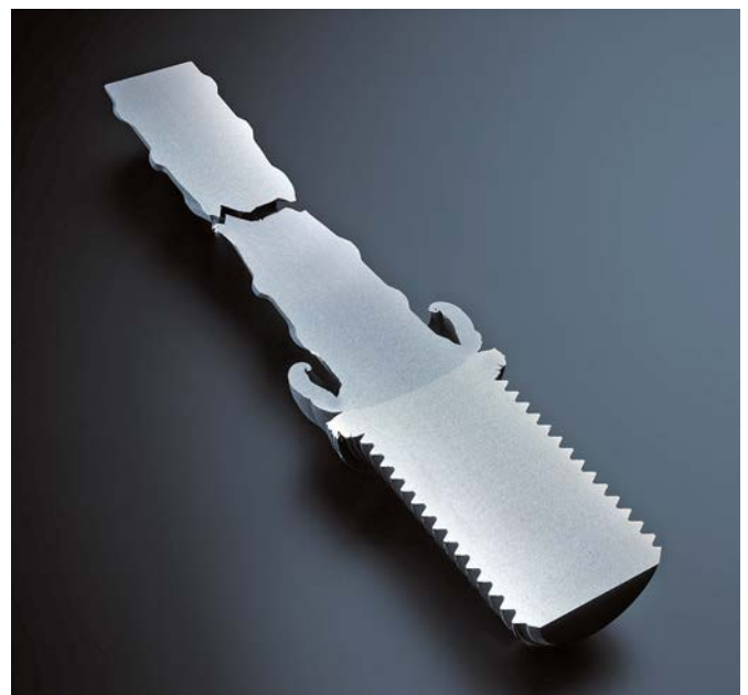
Bild 4 Schnitt durch einen Bolzenanker – nach einem statischen Zugversuch Section through a stud anchor – after statical steel failure test
