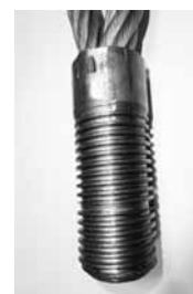
Abb. 38 Gewinde beschädigt
