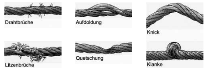
Abb. 37 Seilschäden
